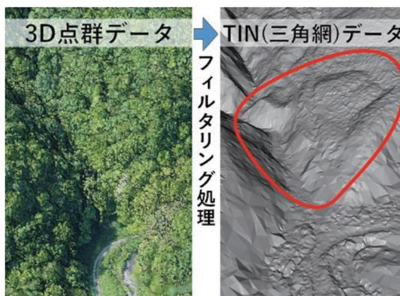
UAVレーザ測量の取得データ
