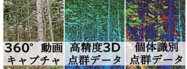
地上レーザ測定(バックパック型)の取得データ
