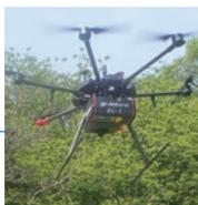
UAVレーザ測量機器
